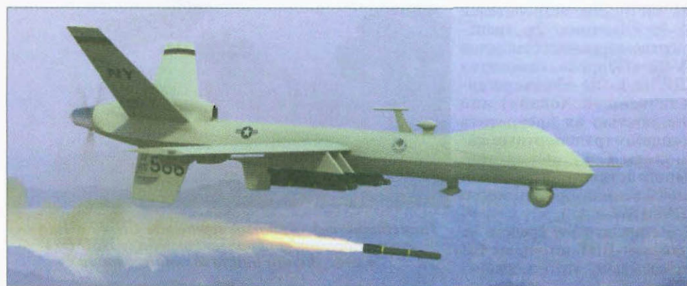
Многоцелевой беспилотный летательный аппарат MQ-9 «Рипер» выполняет пуск бортового авиационного средства поражения
