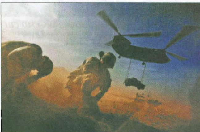
Транспортно-десантный вертолет CH-47 «Чинук» транспортирует бронеевтомобиль HMMWV в ходе учений национальной гвардии
